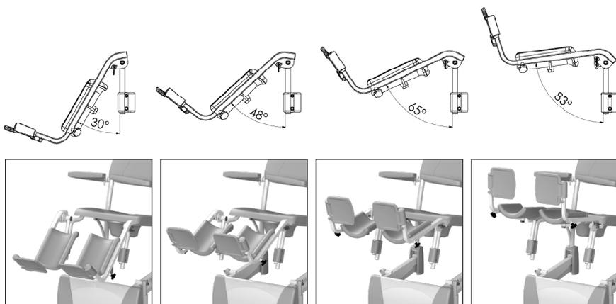
Figure 6 à 9 Possibilité de réglage angle d'assise.
